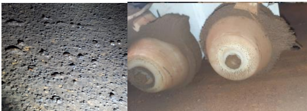
Рисунок 2. Бугристая поверхность водовода и отложения на колесах
