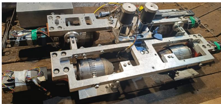
Рисунок 5. Платформа робота с внешним расположением приводов колес
