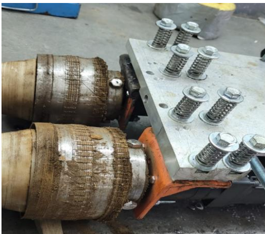
Рисунок 4. Независимая подвеска привода колес
